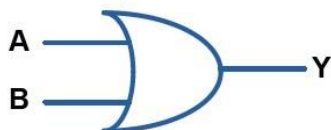
Παλιό σύμβολο λογικής πύλης OR δύο εισόδων
