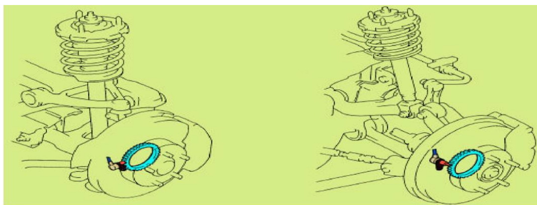
Μαγνητικός αισθητήρας στροφών σε σύστημα ABS
