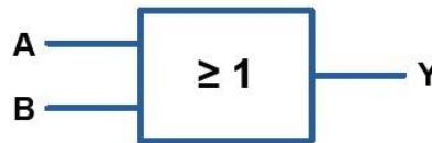
Νέο σύμβολο λογικής πύλης OR δύο εισόδων
